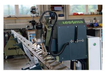
Seit Juli 2023 hat die pro communo AG einen Doppelmesserschleifautomat von der Firma Blessoma in ihrer Werkstatt. Der Messerschleifer kann die aktuell verbauten ESM-Doppelmesser-Mähbalken mit Bidux-System bearbeiten. Wir können Arbeitsbreiten von bis zu 6,00 m schärfen. Der einstellbare Schleifwinkel sichert ein präzises Schleifergebnis.
