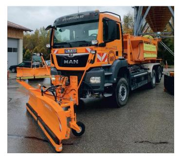
Mit dem neuen LKW erhöhen wir die Schlagkraft der pro communo AG um ein Neues. Der 3-Achser mit Allrad, zwei Triebachsen und Lenk-Lift-Achse hat 430 PS und ein zulässiges Gesamtgewicht von 26 Tonnen.
